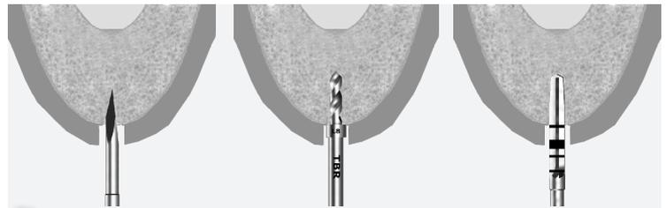
**2** Respecter la séquence instrumentale rotative adaptée au diamètre de l'implant à poser comme indiqué dans la notice de l'implant à l'exception du foret terminal qui sera substitué par l'embout d'expansion osseuse correspondant au diamètre de l'implant.
